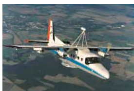
DO 228 D – CODE als Technologie-Demonstrator für natürliche Laminarhaltung bei Verkehrsflugzeugen.
