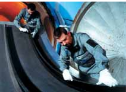
Fertigung von CFK- Rumpf-Sektionen.
