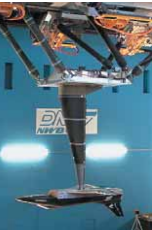
6-Achsenkinematik zur Manöversimulation im NWB.
